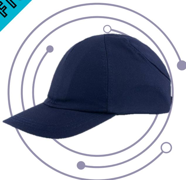
Esta protección está diseñada para evitar raspaduras o laceraciones en el cuero cabelludo por golpes leves, ideal en entornos con riesgo de impactos por herramientas o maquinaria estática. Incluye un casquete de policarbonato con almohadillas internas y externas para absorber golpes, visera estándar de 6 cm, tafilete absorbente y gorra textil ergonómica de estilo béisbol, desmontable y ajustable de 54 a 59 cm por bandas de nuca con hebilla o velcro.
